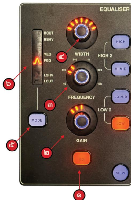
ภาพที่ 16 แสดงปุ่มต่าง ๆ บนแผงควบคุมบนหน้ามิกซ์ EQUALISER ใช้สำหรับปรับโทนเสียง ที่มา : (ภาพถ่ายโดยผู้เขียน, 2569)
