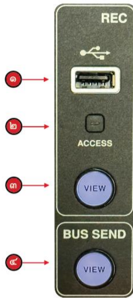
ภาพที่ 18 ภาพแสดงปุ่มต่าง ๆ บนแผงควบคุมบนหน้ามิกซ์ ของแผง REC
