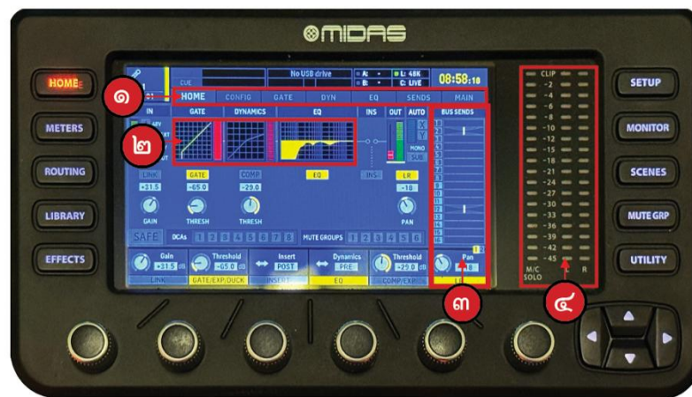
ภาพที่ 22 แสดงการทำงาน หน้าจอหลัก บนแผงควบคุมบนหน้ามิกซ์ ที่มา : (ภาพถ่ายโดยผู้เขียน, 2569)
