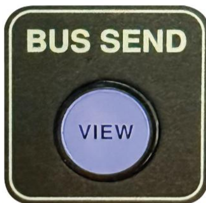
ภาพที่ 19 ภาพแสดงปุ่ม BUS SEND บนแผงควบคุมบนหน้ามิกซ์ ที่มา : (ภาพถ่ายโดยผู้เขียน, 2569)
