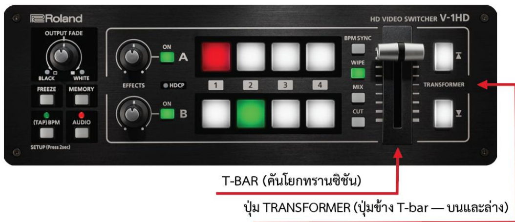
ภาพที่ 36 ปุ่มและการใช้งานเครื่องสลับภาพ
