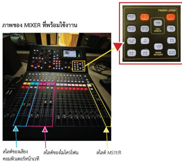
ภาพที่ 8 แสดงสถานะการใช้งานเครื่องผสมสัญญาณเสียง ที่มา : (ภาพถ่ายโดยผู้เขียน, 2569)
