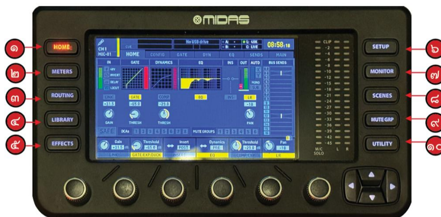
ภาพที่ 21 แสดงปุ่มต่าง ๆ หน้าจอหลัก บนแผงควบคุมบนหน้ามิกซ์ ที่มา : (ภาพถ่ายโดยผู้เขียน, 2569)
