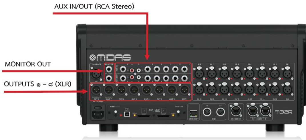
ภาพที่ 27 แสดงช่อง OUTPUT ด้านหลังเครื่องมิกซ์ ที่มา : (ภาพถ่ายโดยผู้เขียน, 2569)
