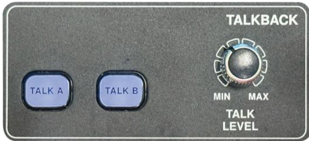
ภาพที่ 11 หน้ามิกส์ในส่วนของ TALKBACK เครื่องผสมสัญญาณเสียง ที่มา : (ภาพถ่ายโดยผู้เขียน, 2569)
