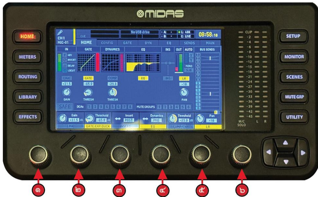
ภาพที่ 23 แสดงปุ่มต่าง ๆ หน้าจอหลัก บนแผงควบคุมบนหน้ามิกซ์ แถวปุ่มหมุน (Encoders) ใต้จอ ที่มา : (ภาพถ่ายโดยผู้เขียน, 2569)
