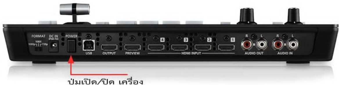
ภาพที่ 32 แสดงวิธีการเปิด/ปิด เครื่องสลับสัญญาณภาพ
